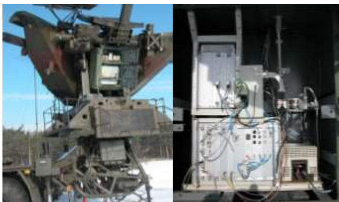
Zdjęcie 1. Kolumna antenowa PZR NEWA SC z nowym zespołem nadawczo odbiorczym
